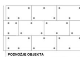
5 pričvrstnica/ploča ili 8 kom/m 2 fasade
