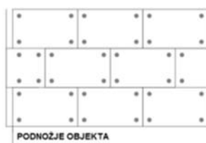
4 pričvrstnice/ploča ili 6 kom/m 2 fasade
